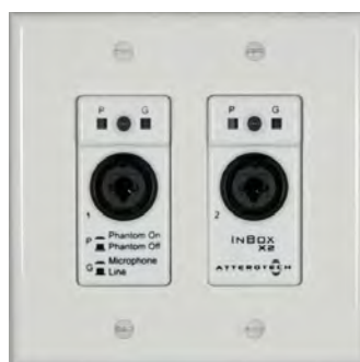
Fig. 7.36: Terminação de rede CobraNet
