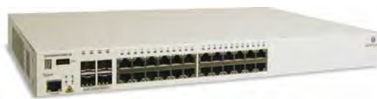
Fig.1: switch com 24 portas fixas
